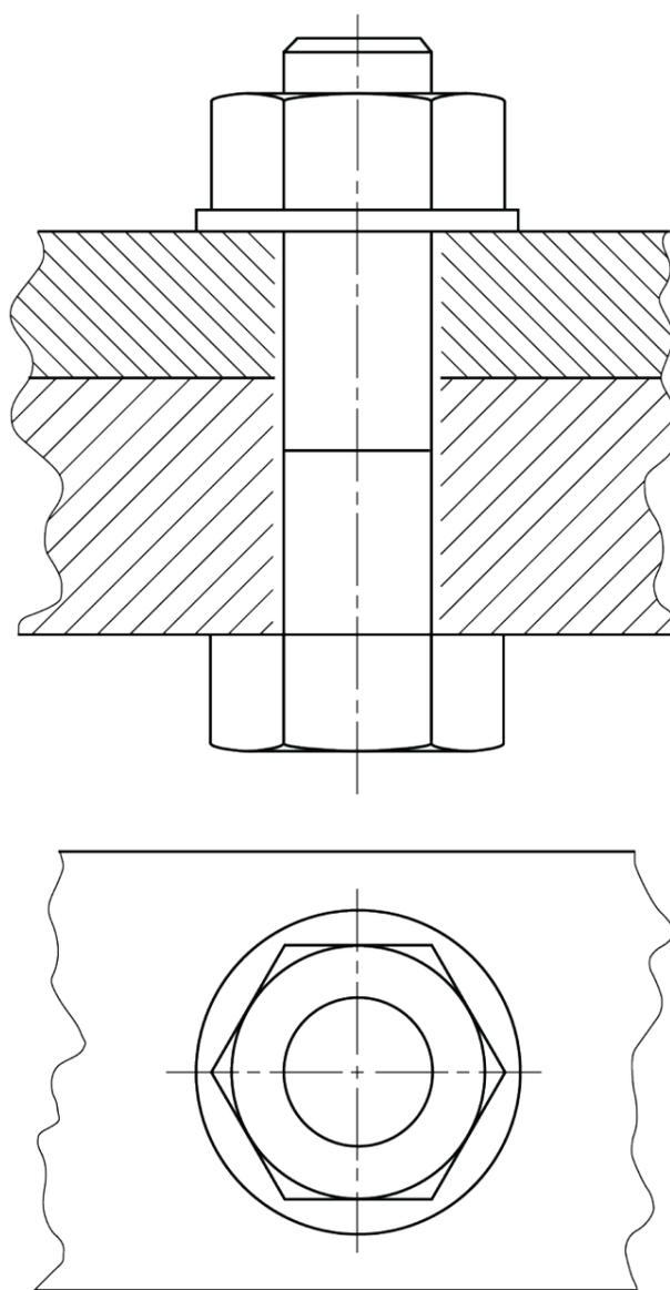
四、标注零件图尺寸及公差，尺寸数值按 1:1 从图中量取，并取整数；螺纹为粗牙普通螺纹，图中①处为基准孔，公差等级 IT7；铸造圆角 R1。(20 分)
